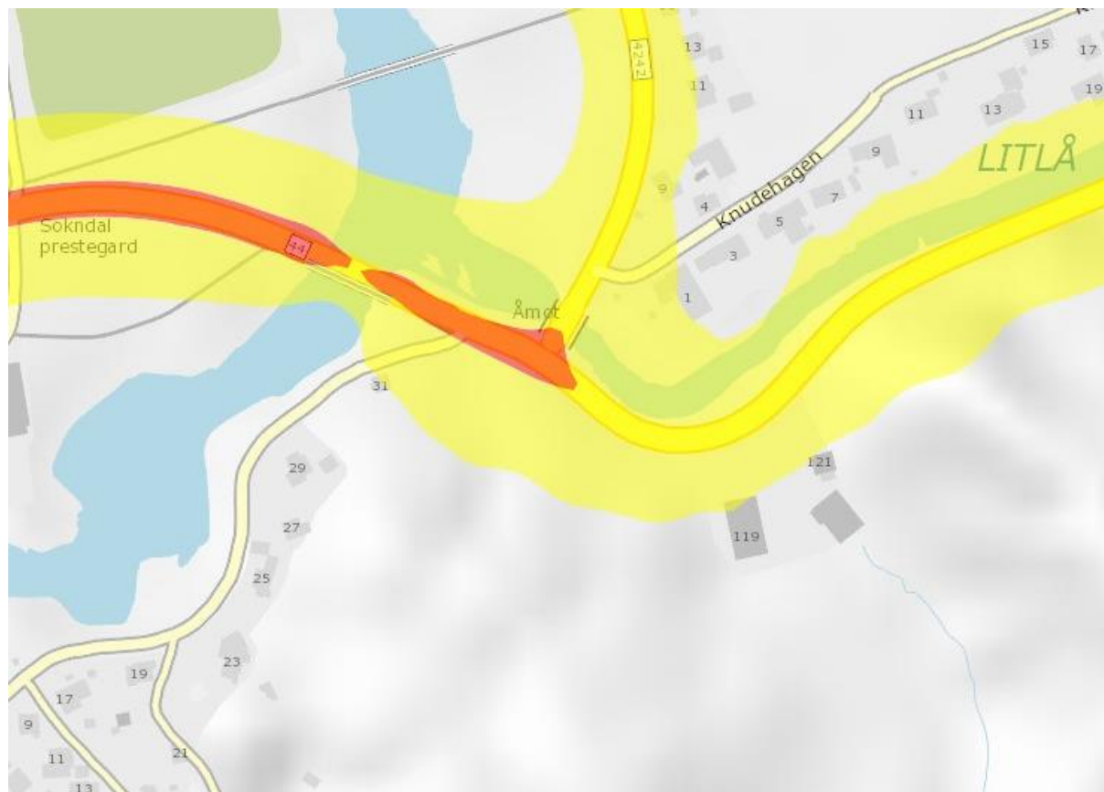
Figur 14: Kartutsnitt som viser utbredelse av vegtrafikkstøy fra FV 44 og Fv 4242. Kilde: vegvesen.no
